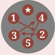
Il est indispensable d'enclencher le frein de parking et de caler le tracteur. Le déboulonnage doit se faire en croisant et alternant les écrous. Laisser un dernier écrou légèrement serré pour maintenir la roue en place.
